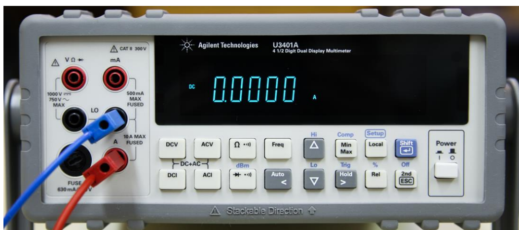
Slika 1: Ampermeter na 5 A merilnem območju
