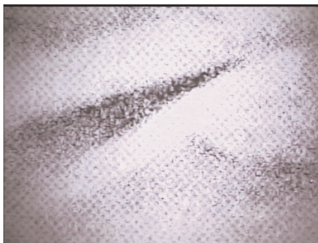
SLIKA 18: Povečava detajla enobarvne večtonske reprodukcije, odtisnjene v tehniki globokega tiska s konvencionalno, fotomehanično izdelano tiskovno formo.
