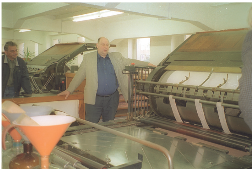
SLIKA 16: Tiskarski stroj za tiskanje v tehniki litografije in svetlotiska.
