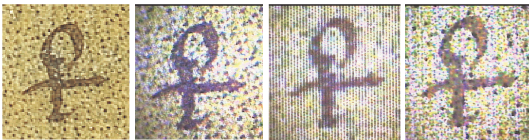
SLIKA 25: Povečava detajla rokopisa na originalu, odtisu v konvencionalnem ofsetnem tisku s stohastičnim rastriranjem, v elektrofotografiji (xerox) in v kapljičnem tisku (epson).
