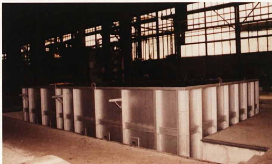
Peč bo najprej namenjena za predgrevanje, kasneje pa še za žarjenje.
