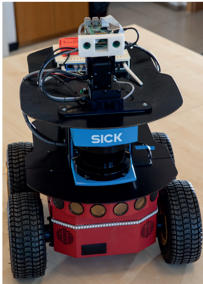
Testni avtonomni mobilni sistem za gradnjo zemljevidov prostora, lokalizacijo in vodenje po začrtani poti
