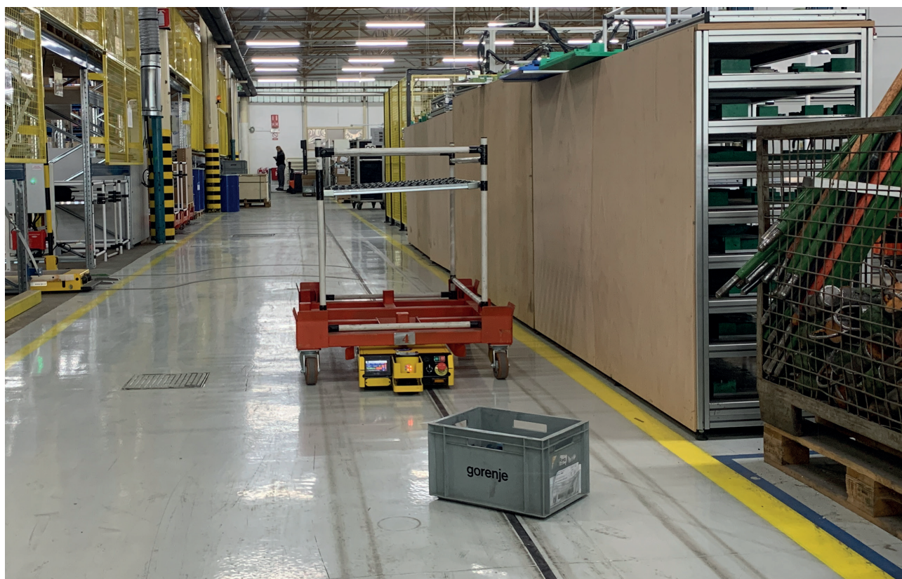
Testni avtonomni mobilni sistem za gradnjo zemljevidov prostora, lokalizacijo in vodenje po začrtani poti
