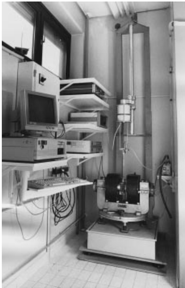
Slika 4: Vzorec je pritrjen na konec palice, ki jo trese elektromehanski pretvornik, in le-i v homogenem polju elektromagneta. Na desni strani je pripravljena rotacijska ~rpalka za evakuiranje epruvete z vzorcem
