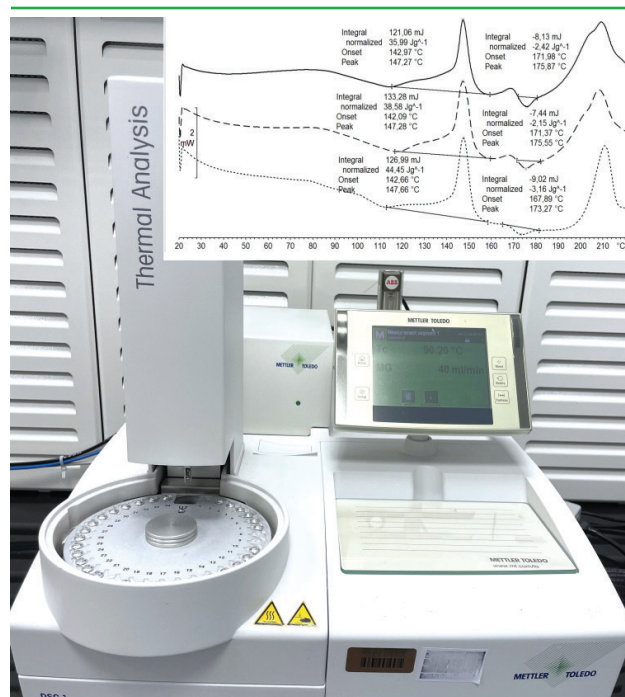
Slika 1: Primer aparature za dinamično diferenčno kalorimetrijo in izpisa termične analize. Vir fotografije: arhiv podjetja Krka, d.d., Novo mesto.
