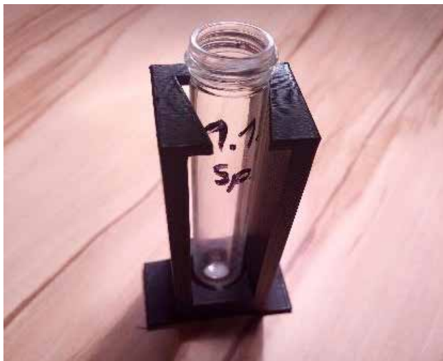
Slika 16 : Sušenje delcev v odprti epruveti na podstavku
