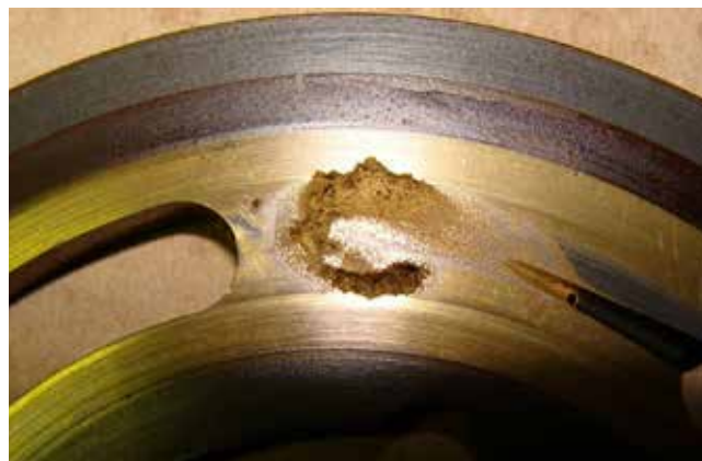
Slika 3 : Posledica kavitacijske obrabe na ventilski plošči hidravlične črpalke [6]
