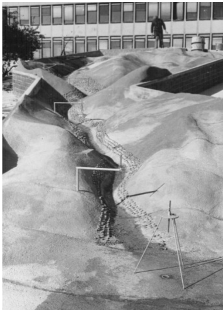
Slika 67: Fizični model akumulacije Kolarjev vrh in južne doline pod pregrado (Legiša in Rajar, 1980)
