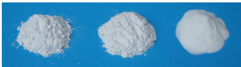
Slika 3.5: Steklene mikrokroglice kot suspendirana snov: levo granulacija A, na sredini granulacija B, desno granulacija C
