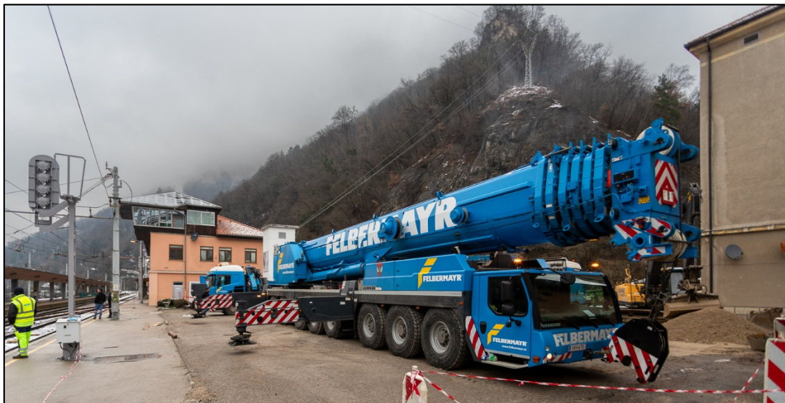
Postavljanje kolesnega žerjava LTM 1450-8.1, 18. januar 2023 (avtor: Bojan Dremelj)
