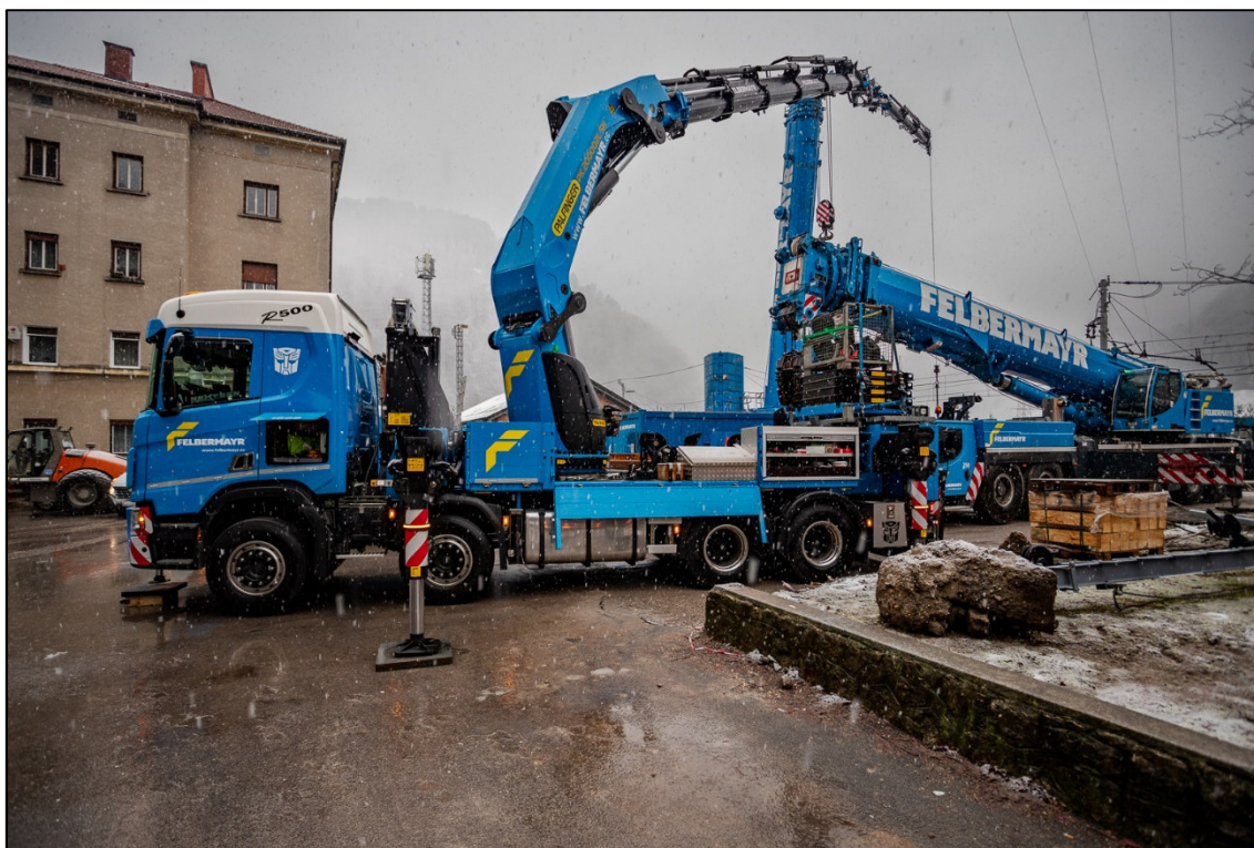
Avtodvigalo s podaljškom kraka, v ozadju LTM 1350-6.1, 19. januar 2023 (avtor: Bojan Dremelj)
