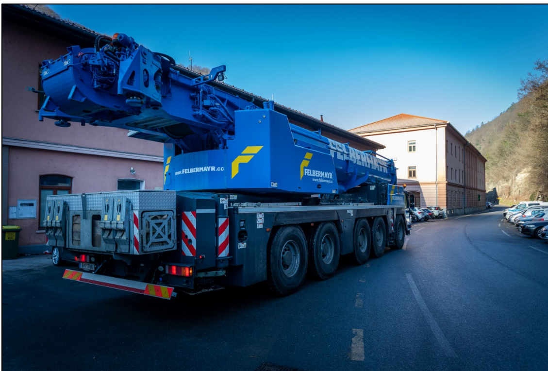
Pogled na zadek kolesnega žerjava LTM 1230-5.1, 31. januar 2023 (avtor: Bojan Dremelj)
