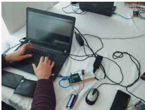
Slika 24: Sestavljanje merilnika za prikazovanje temperature in relativne vlažnosti zraka na otoku 2.
