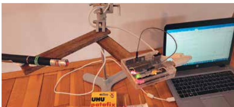
Slika 19: Svetlobna vrata, sestavljena iz laserskega kazalnika in fotodiode.
