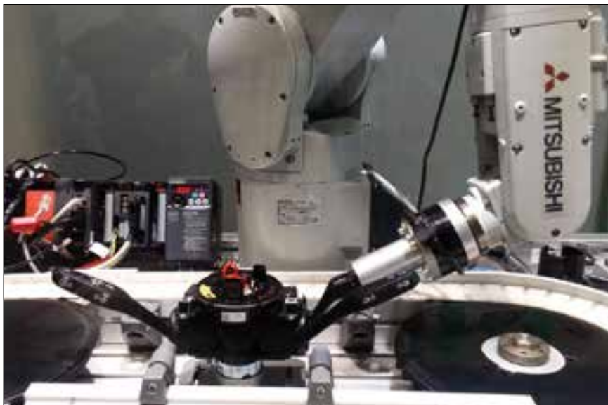
Slika 5. Robotizacija preverjanja kakovosti končnega sestava obvolanskih ročic v kombinaciji s senzorjem sile
