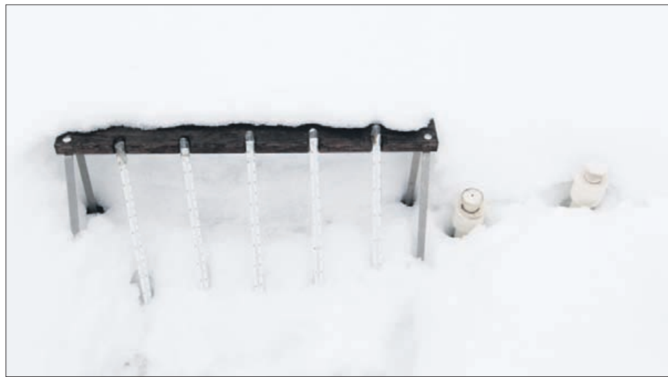
Takole merijo temperaturo v zemlji. V torek, ob 9.30 uri, ko smo bili v Medlogu tudi mi, je bila temperatura zemlje na 50 centimetrih pod površino 3,5 stopinje, meter pod površino pa natanko 5,1 stopinje.
