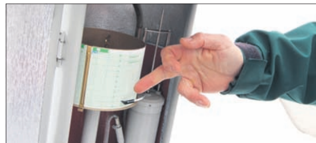
Ombrograf. Aparat, ki meri intenziteto padavin. V torek je graf pokazal, da je zgodaj zjutraj v Celju rahlo deževalo, čeprav se vam bo morda zdelo, da ni. Aparat je namreč tako točen, da zelo natančno zaznava, kaj se dogaja.
