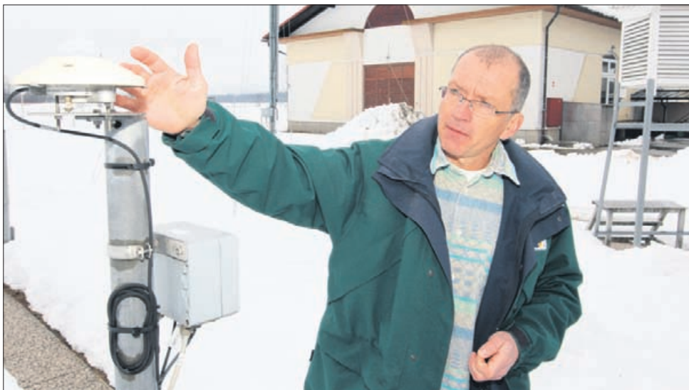
Tole je pa nadvse zanimiv piranometer, ki meri moč sončnega sevanja. Sevanje je večje, čim višje je Sonce in čim manj je oblakov.
