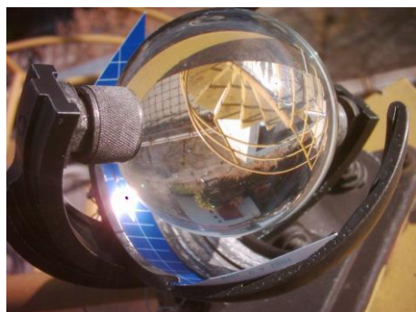
Slika 8. Heliograf na postaji Ljubljana Bežigrad slikan novembra 2004. V piki na modrem traku so zbrani sončni žarki izžgali sled (arhiv ARSO) Figure 8. Heliograph on station Ljubljana Bežigrad, photo made in November 2004 (archive ARSO)
