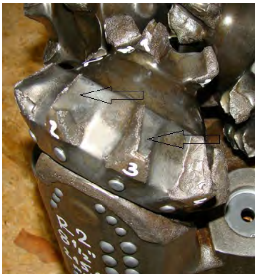
Slika 7. Karakteristične poškodbe kotalnega dleta
