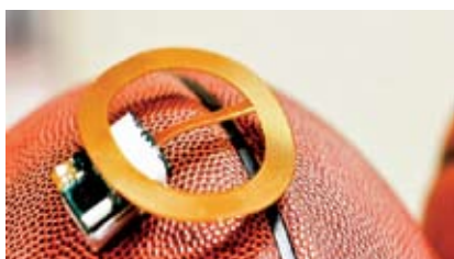
Slika 2: Vztrajnostni senzor za zaznavanje gibanja, ki je patentiran znotraj 94Fifty® žoge.
