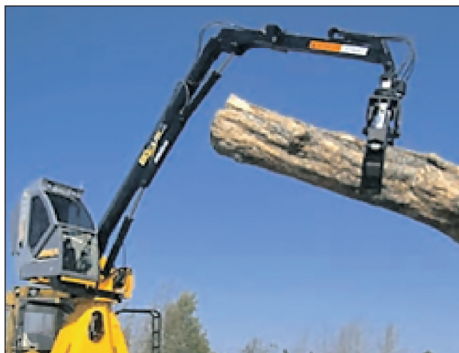
Slika 1. Tlačnim konicam se pri delovanju hidravličnega sistema ob pospeševanju in zaviranju lahko izognemo z uporabo “mehkih” prelivnih ventilov.
