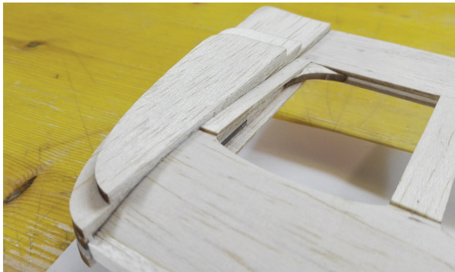
Zaključka kril sta sestavljena iz balze in nosilnega dela iz ELSV, ki konca kril lepo okrepi. Dele zlepimo in jih obdelamo v želeno obliko.
