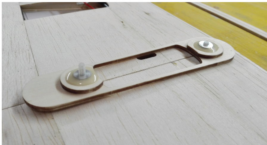
Preden v trup vlepimo nosilno ploščico za krila, je dobro preveriti, ali se ta lepo prilega krilu.
