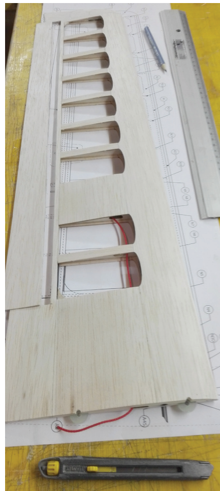
Ko je krilo končano, izrežemo krilci, ju obrusimo, nanju prilepimo dodatni letvici in ju z obeh strani pobrusimo pod kotom, potrebnim za ustrezen odklon kril.
