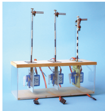
Sprega RV-servomotorčkov z likovnimi signali. (Foto: Saša Ogrizek)
