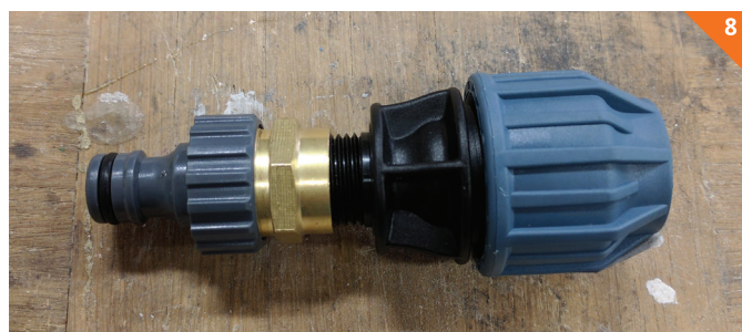
Sestavljen moški del hitre spojke, reducirnik in nastavek za alkalne cevi
