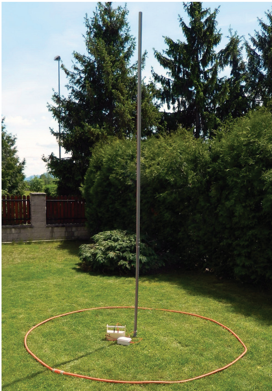
Postavljen antenski drog z anteno, mini oddajnikom in akumulatorjem
