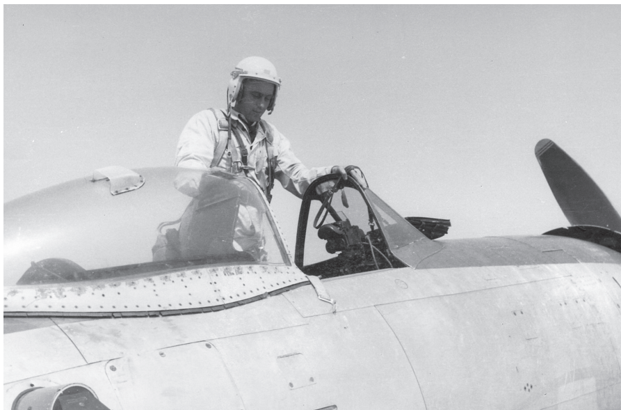
Detajl pokrova kabine in vetrobrana F-47D. Na pokrovu kabine je prezračevalna odprtina. Lepo je vidna tudi namerilna naprava z zaščito, ki je deloma obvarovala pilota pri zasilnem pristanku. (Zbirka Marka Malca).
