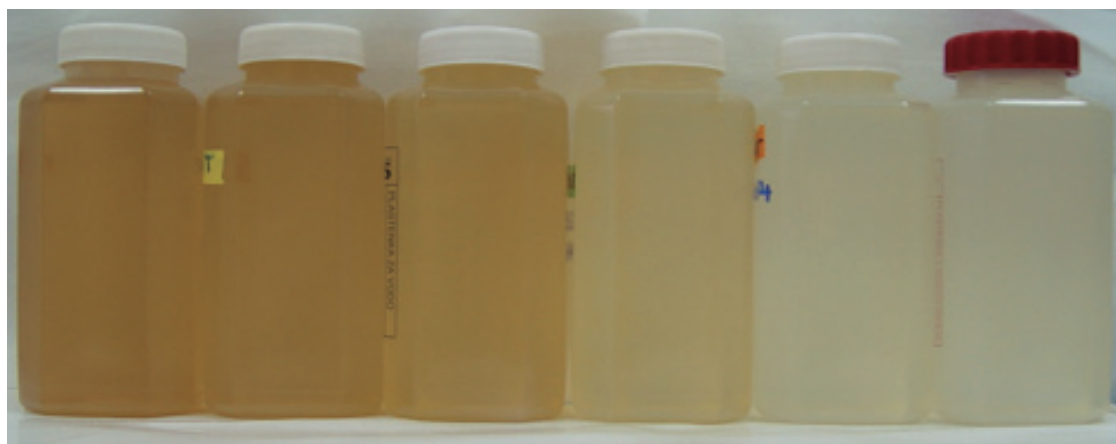
Slika 5: Razbarvanje, z leve proti desni: začetni vzorec (filtrat MBR) ter vzorci pri dozi ozona 12,5, 25, 50, 100 in 163 \text{g m}^{-3}
