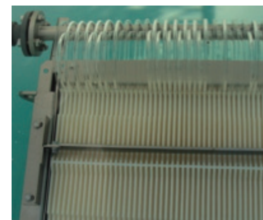
Slika 2: MBR modul (čista voda)
