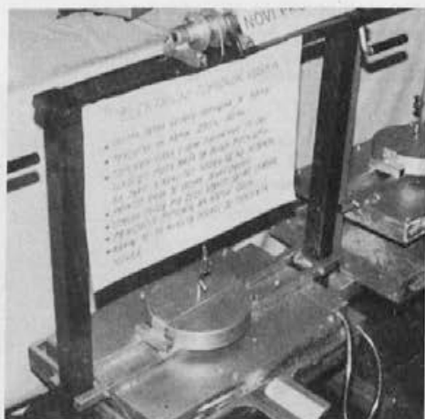
Električni topilnik voska. Segreta plošča, težka 25 kg, pritiska na sat pod njo in topi vosek.
