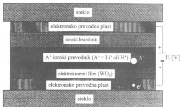
Slika 5 Shema elektrokromnega (EC) sklopa iz petih aktivnih plasti
