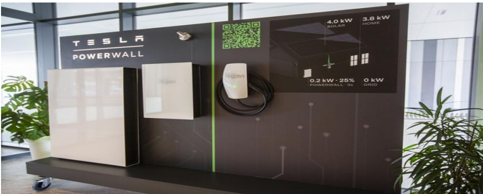
Slika 3: Demonstracijski pano z dvema baterijskima hranilnikoma in polnilnico za e-avto (vir: lastni Javeršek, 2025)
