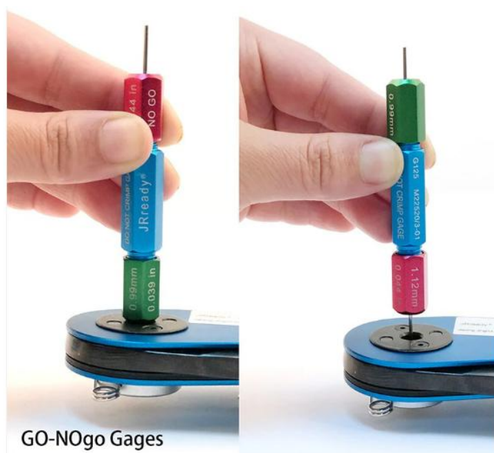
Slika 4: Princip delovanja kontrolnika GO-NOGo
