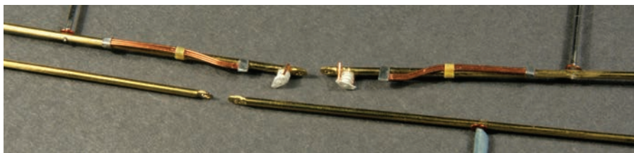
Fotografija detajla izdelave predalčnega trupa. Osnovna nosilca sta iz medeninastega profila premera 1 mm, prevrtna za navpične opornice, ki so iz jeklene žice. Na okrogle opornice so nataknjene injekcijske igle, aerodinamične opornice pa so oblikovane iz pokitanega in zbrušenega ličarskega traku. Različne podrobnosti so upodobljene iz bakrenih žic in plastike različne debeline.
