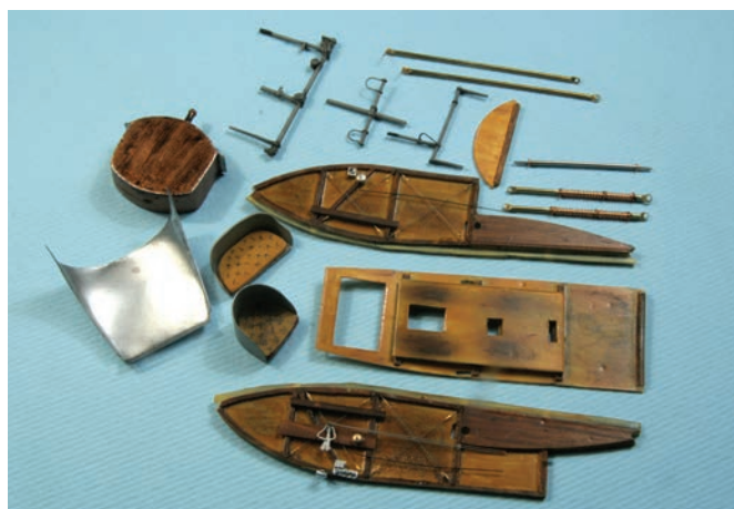
Izdelani in pobarvani deli sprednjega dela trupa pred sestavljanjem in lepljenjem
