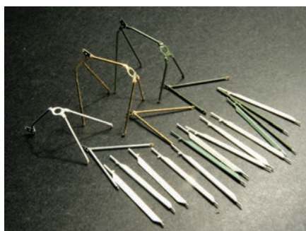
Zunanje opornice kril in oporni nosilci motorja
