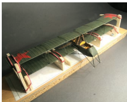
Makete je med sestavljanjem vpeta v šablone, opornice so prilepljene, sledi napenjanje žic. V ta namen sem uporabil tenek ribiški laks, ki sem ga pobarval s črnosrebrno barvo in ga na pritrditvenih mestih prilepil s sekundnim lepilom.
