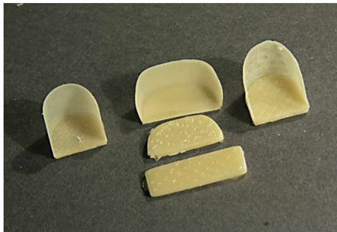
Poliuretanski odlitki sedežev so še neobrušeni. Potrebno je še vrtanje lukenj v naslon.
