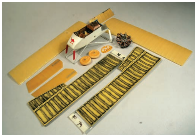
Sestavni deli ene od maket. Sprednji del trupa je v glavnem končan, spodnja dela kril sta grobo pobarvana, deli zgornjih kril in repne površine pa so še neobdelani.
