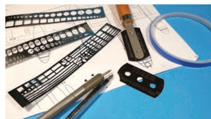
Orodje, potrebno za graviranje panelnih linij
