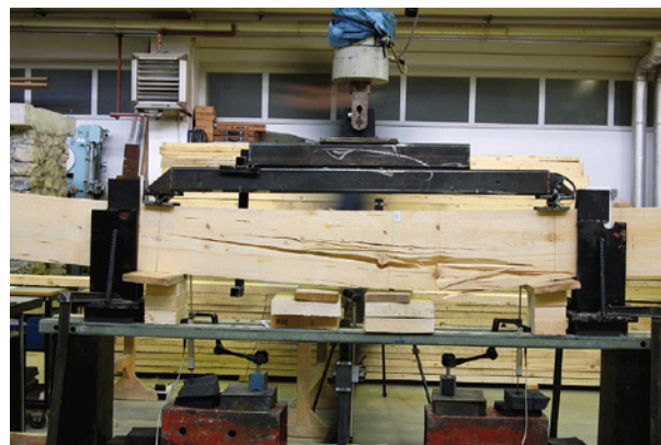
Slika 6. Detajl porušitve (foto: arhiv ZAG)
