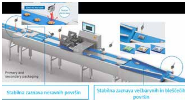
Slika 2 : Zanesljivo zaznavanje neravnih in bleščečih površin
