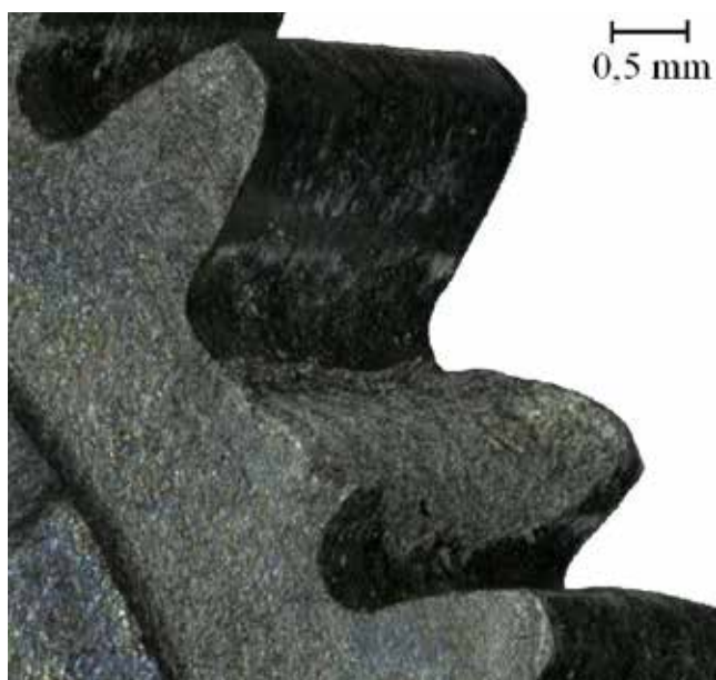
Slika 1 : Lom v korenu zoba zaradi utrujenosti materiala (PPS z ogljikovimi vlakni)
