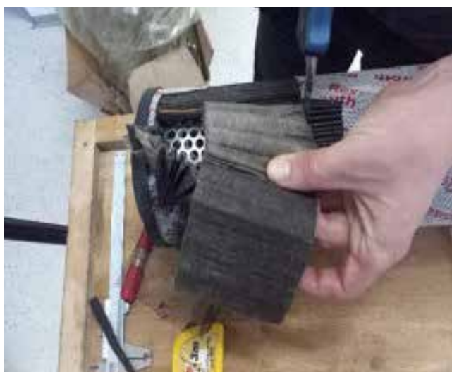
Slika 10 : Izrezovanje dela filtra
