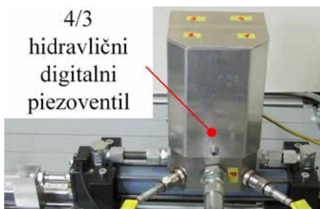
Hidravlični digitalni piezoventil, vključen v pogon
