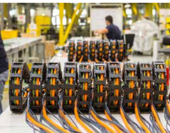
Slika 1: Kabli chainflex®, vgrajeni v energijsko verigo
