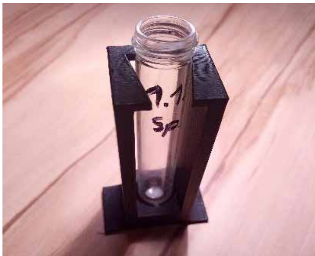
Slika 16 : Sušenje delcev v odprti epruveti na podstavku
