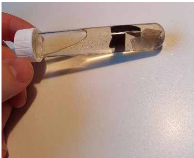
Slika 12 : Vzorci filtra v epruveti, zaliti z alkoholom
