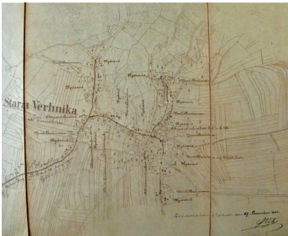
Načrt vodovodne napeljave na Stari Vrhniku iz leta 1901 (Stara Vrhnika, osebni arhiv Eme Goričan)
