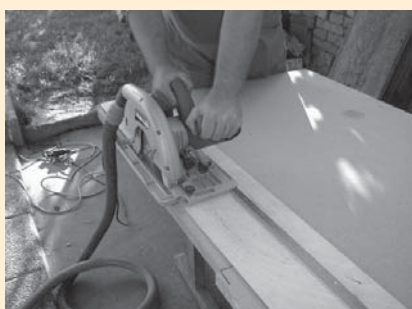
□ Slika 6. Uporaba priročne vodilne šablone za ravno odžaganje
