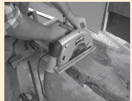
□ Slika 1. Prečno žaganje. Podobno lahko je bilo tudi žaganje z drugim - delno topim - listom, kar kaže na primerno razmerje med močjo, velikostjo lista in številom vrtljajev. Žag je bil kvaliteten in gladek.
