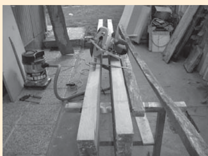
□ Slika 5. Razžagan plošč, gladkost žaga je primerna
