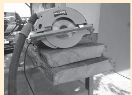
□ Slika 2. Prečno prežagan hrastov plošč debeline 65 mm
