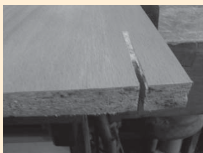
□ Slika 7. Preskus natančnosti po prestavitvi globine - širina žaga 3 mm, odstopanje 0,7 mm
