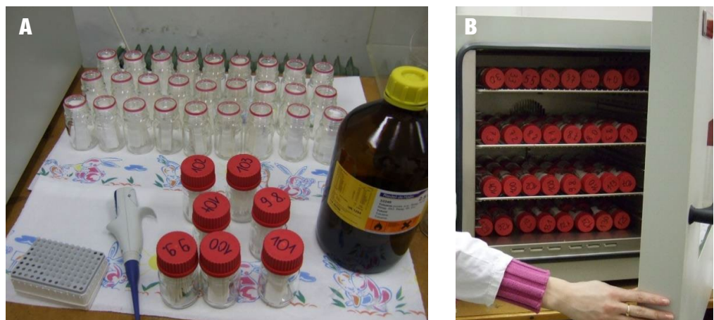
Slika 26: Preiskovani material, nameščen v steklenih posodah (A), in steklene posode v sušilniku s kontrolirano temperaturo (B)
