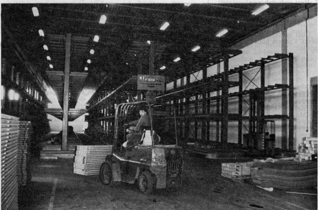
Skladišče vrat v TO Rečica - Sodobno skladiščenje je pogoj za zmanjšanje poškodb in okvar izdelkov. Prostor je racionalno izkoriščen, preglednost zaloga je večja.
