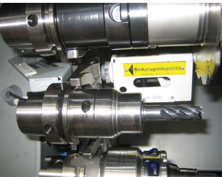
Vpenjalno glavo APC odlikujeta visoka stopnja togosti in dušenje vibracij.
