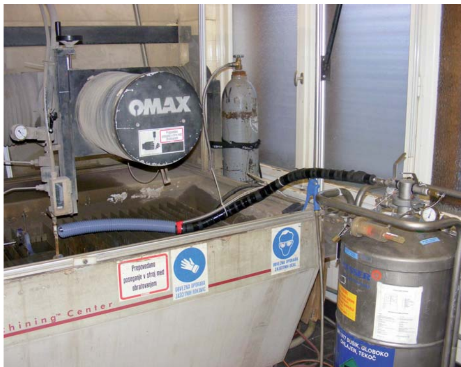
Slika 4: Naprava za obdelavo z abrazivnim vodnim curkom, prilagojena za ustvarjanje ledenega zrna z injekcijo tekočega dušika
