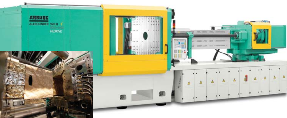
Največji brizgalni stroj iz Lossburga: a) Allrounder 920 H, b) orodje za izdelavo vrečke (foto: Arburg in Messe Düsseldorf)
