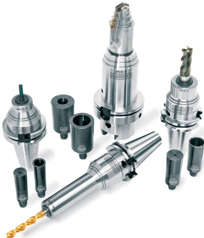
Serijski patentirani vpenjalni glav APC je primerna za rezkanje, brušenje, razvrtavanje in rezanje navojev. Na razpolago so glave za vpenjanje obsegov od 2 do 32 mm.
