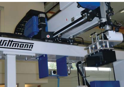
Robot W821 WITTMANN z vgrajeno termokamero (foto: Wittmann Battenfeld)
