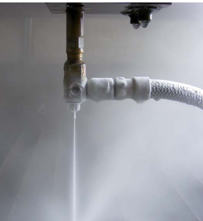
Slika 3: Transformacija vodnega curka v ledeni curek z injekcijo utekočinjenega plina
