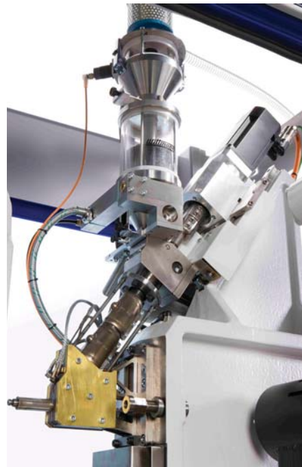
Enota za brizganje na brizgalnem stroju MicroPower 5 (foto: M. Katalenić, Wittmann Battenfeld)
