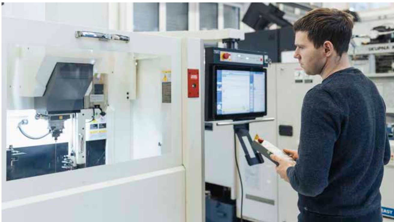
Slika 2 : Visoko natančni 3D mikro EDM (elektro-erozijska obdelava) CNC obdelovalni stroj (Foto: IFP, d. o. o.)
