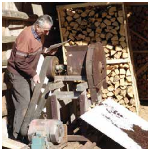
Mlin, ki so ga nekoč uporabljali za mletje šote za potrebe vrtnarij. Lastnik mlina Janez Vonča iz Bevk.
