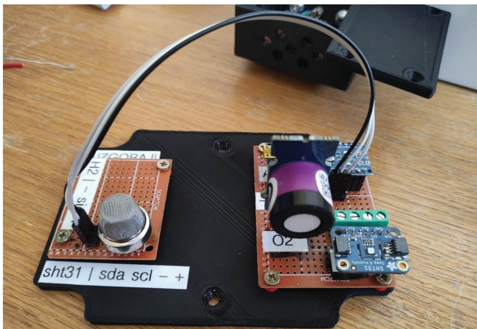
Slika 4: Komponente zgornje senzorske enote v notranjosti komore (ENOTA A)
