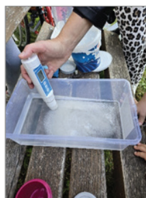
Slika 5 Mjerenje slanosti salinometrom
