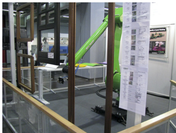
Slika 9. CMA 6-osni CNC robot za lakiranje (foto: A. Kobe)
