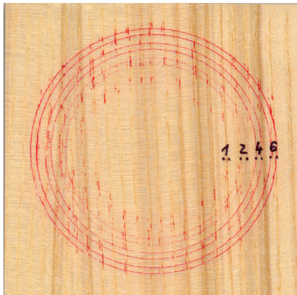
Slika 2. Vzorec z začetno mikrorazo pri sili 2 N (foto: M. Pavlič)
