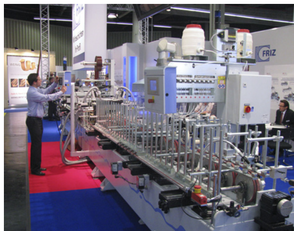
Slika 11. Strojna linija FRIZ za oplašanje (foto: A. Kobe)
