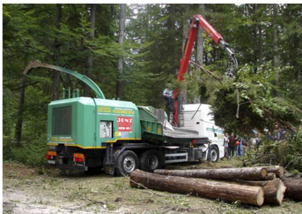
Slika 2. Izdelava lesnih sekancev iz sečnih ostankov neposredno na skladišču ob gozdni cesti (foto: N. Krajnc)
