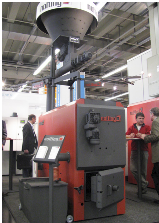
Slika 12. Kotel NOLTING za kurjenje z ostanki ivernih plošč, vlaknenih plošč in drugimi ostanki (foto: A. Kobe)
