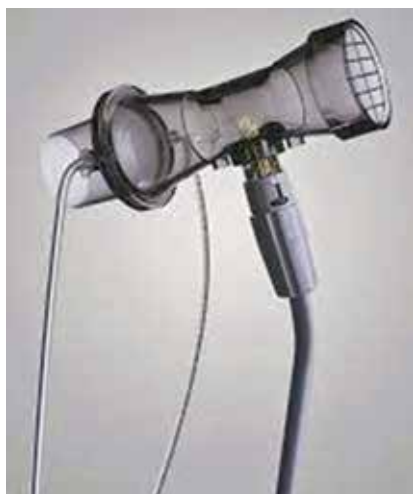
Slika 8. Šoba za merjenje pretoka predihanega zraka, levo, izkorišča značilnosti Venturijeve cevi (Sensor Medics Yorba Linda Kalifornija). Klasičen način merjenja ventilacije prikazuje desna slika, ki kaže ohišje s turbino. Ta se med dihanjem vrti s proporcionalno kotno hitrostjo, kot znaša pretok zraka (Cosmed K4 ali 5, Rim, Italija).
