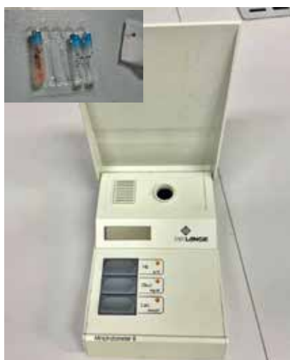
Slika 16. Prenosni analizatorji mikrovzorcev krvi: dr. Lange LP20, ki uporablja kivete in klasično fotometrijsko tehnologijo, Accusport, ki uporablja merilne lističe, na katerih poteka reakcija, in Lactate Pro 2 (Arkay, Japonska), ki edini omogoča samo eno meritev (specifičen za vsebnost laktata) na merilnih lističih.
