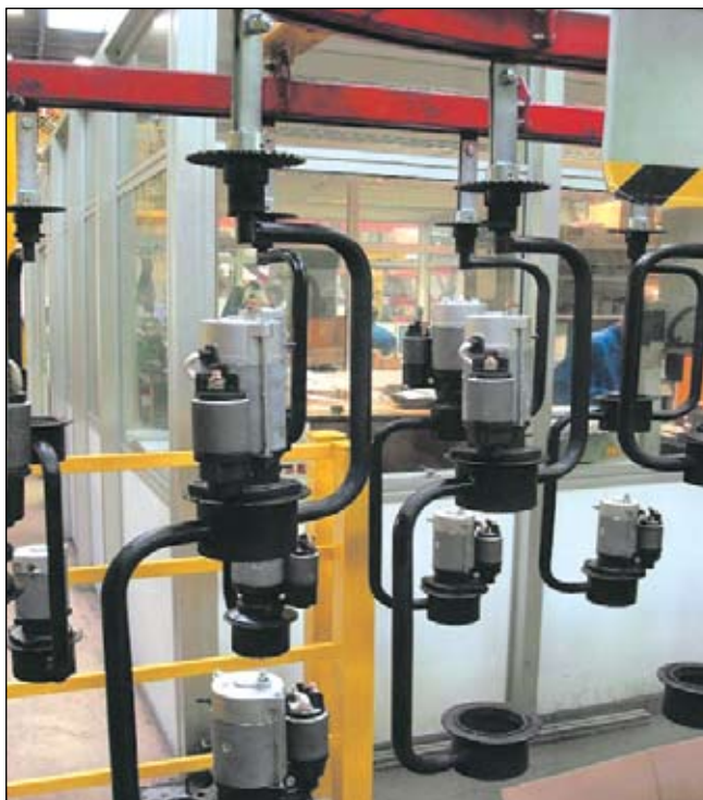
Slika 2. Transportni trak z izdelki pred lakirnico
