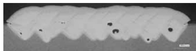
Slika 16: Dvoslojni navar na predhodno pretaljeni nitrirani površini
