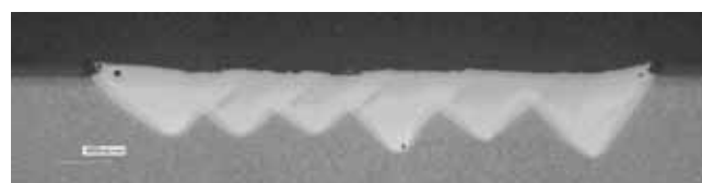
Slika 15: Predhodno pretaljevanje nitrirane površine
