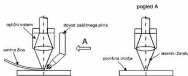
Slika 5: Shematski prikaz taljenja tanke žice pod laserskim žarkom (5)
