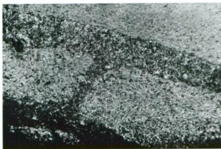
Sl. 6. Žilice sadre (temno) v anhidritu (sivo). Vzorec 5, rudišče Ljubevč. \times nikoli, 8\times Fig. 6. Gypsum veinlets (dark) in anhydrite (gray). Sample 5, Ljubevč mine. \times nicols, 8\times
