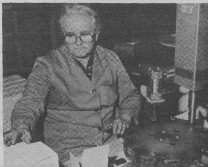
Alojzija Kutnar pri varjenju baterij 6BF22 z ultrazvokom.
