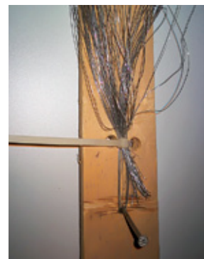
Okoli dveh žebeljev, v medsebojni razdalji, ki določa primerno dolžino žice za satnik, razvijemo kolut žice. Na obeh koncih žico odrežemo s kotno brusilko.
