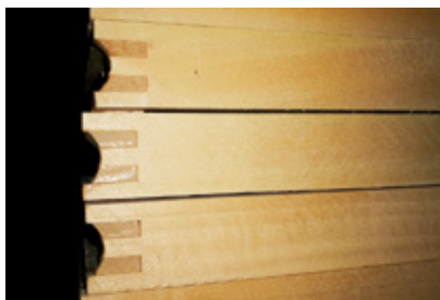
Satnik z rogljičnim in lepljenim spojem
