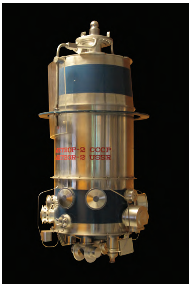
Model meteorološkega satelita Meteor, s katerim je leta 1971 Sovjetska zveza demonstrirala uporabnost Hallovega ionskega pogona. Z ionskim motorjem, ki ga je razvil Aleksej Morozov, so dvotonskemu satelitu v dveh tednih zvišali višino tirnice za 15 kilometrov, kar je omogočilo dolgoročno delovanje tega satelita. Kasneje sta Sovjetska zveza in Rusija na različnih satelitih uporabili podoben motor še približno dvestokrat. Foto: MediaCommons.
