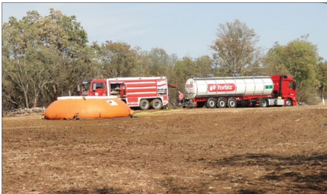
Slika 5: Oskrba heliporta na požaru na Krasu z gasilsko avtocisterno (GVC 3) s 13 000 l vode in polpriklopnikom pogodbenega izvajalca s 25 000 l vode (foto: J. Saražin).
