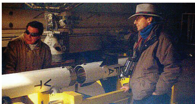
Sestavljanje stopenj rakete v montažni hali
