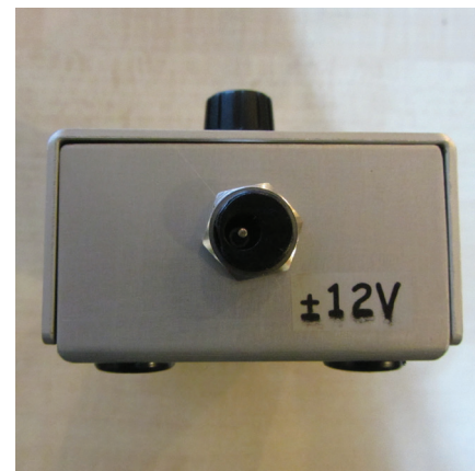
Primer označevanja na krmilniku: Napajalni konektor K2
