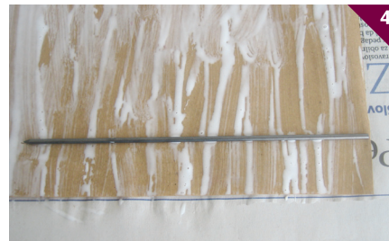
Polaganje grafitne mine na papir, premazan z lepilom
