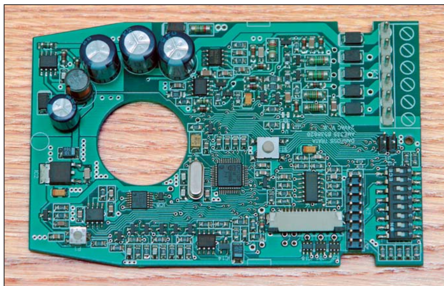
Elektronski sklop za pogon motorja inteligentnega ventila
