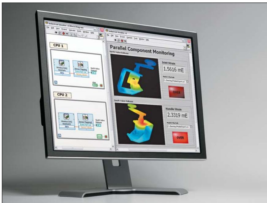
NI LabVIEW 8.6-večjedrno procesiranje ter mapiranje senzorjev
