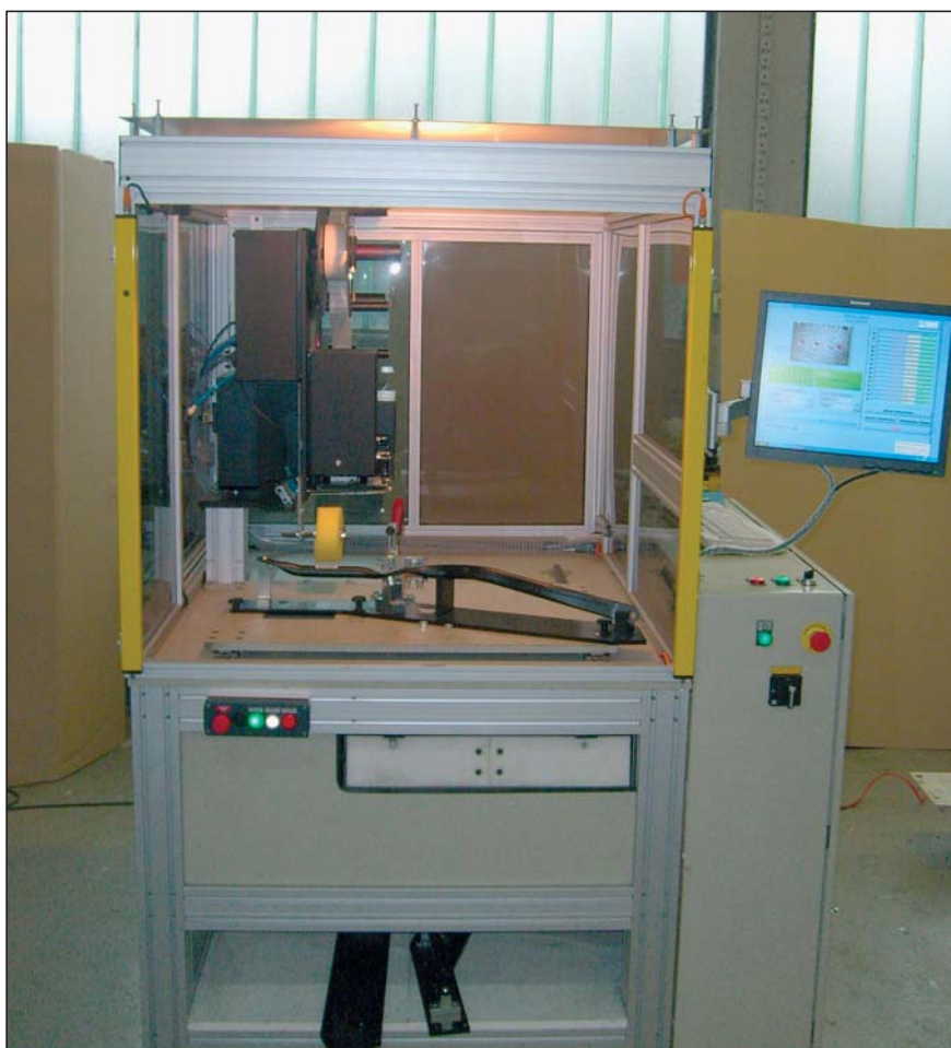
Svetlobna varnostna zavesa in primer uporabe
