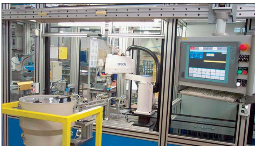
Slika 4. Montaža keramičnih elementov
