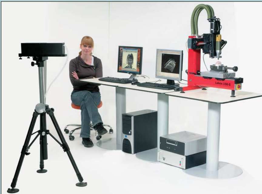
Sistem za lasersko merjenje in izdelava tridimenzionalnih oblik (vir: LAKOS, Fakulteta za strojništvo)
