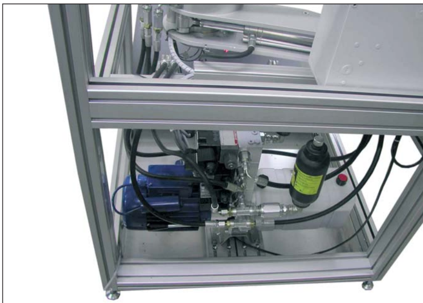
Slika 4. Mini agregat z blokom ventilov in pomožno ročno črpalko
