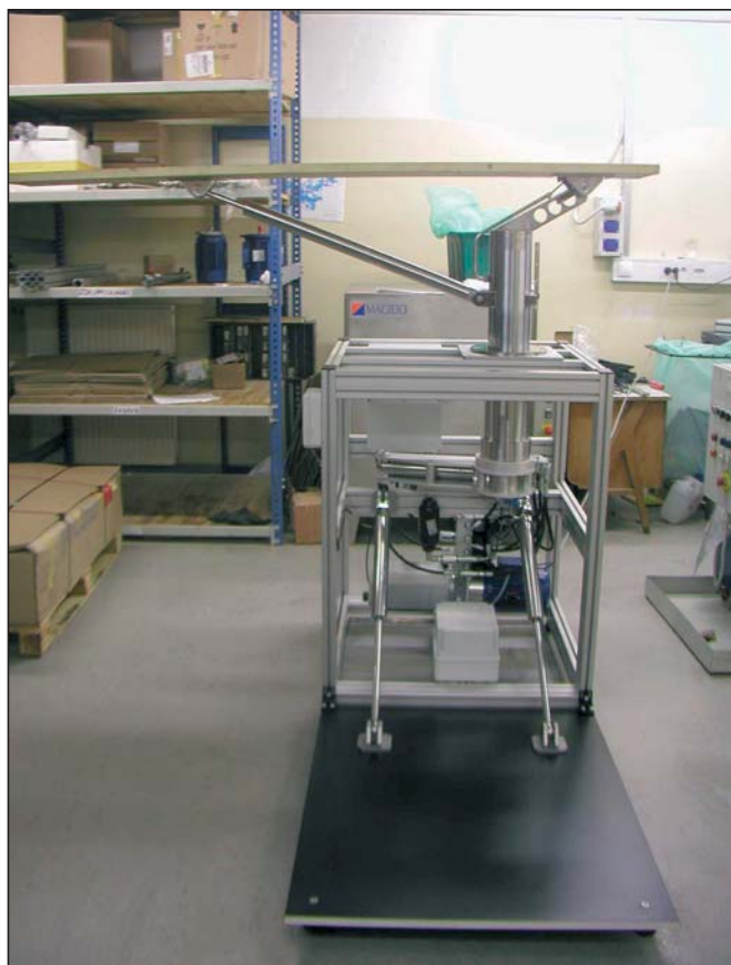
Slika 1. Videz mostiča s pogonskim in krmilnim sistemom
