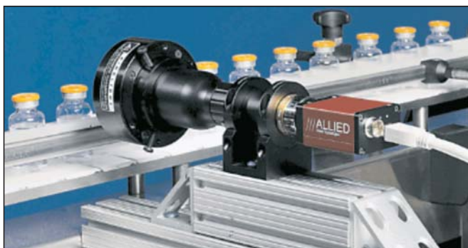
Slika 6. Primer aplikacije strojnega vida v kontroli [17]
