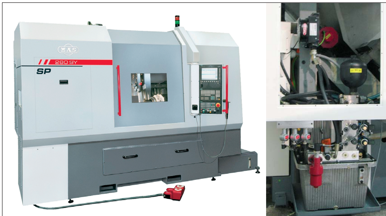
Slika 4. Stručnica (levo) in vgrajeni hidravlični agregat z elektronskim nadzorom tlaka (desno)
