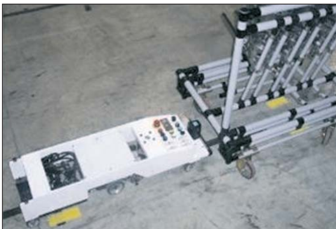
Slika 8. Avtomatsko vodeno vozilo (AGV) z integriranimi najnovejšimi tehnologijami [19]
