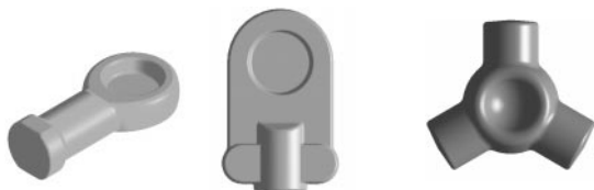
Sl. 6. Modeli, uporabljeni pri računalniškem simuliranju postopka kovanja
