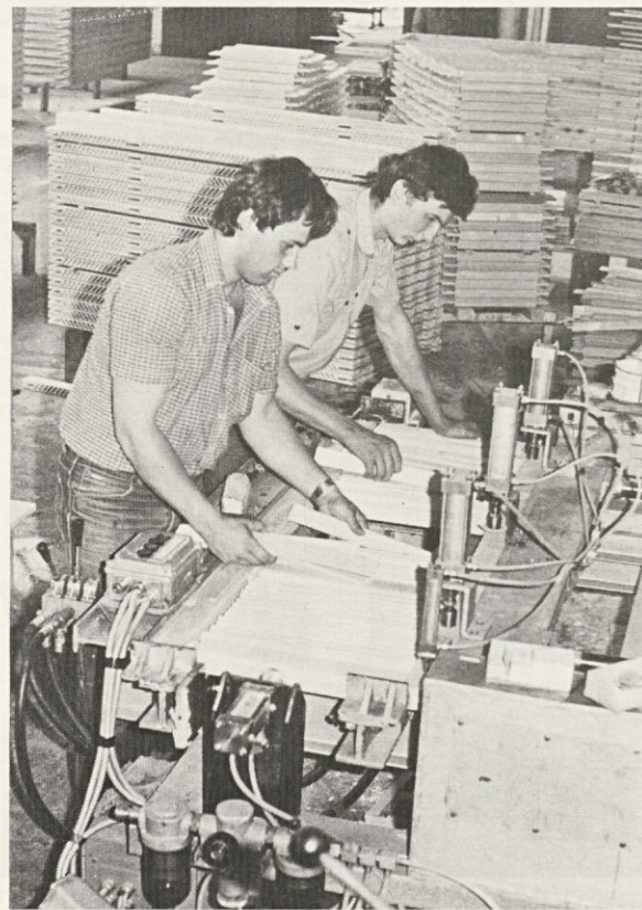
Stiskalnica za polkna (Izdela Janez Sever z ekipo) je uspešno nadomestila predhodno ročno sestavljanje.
