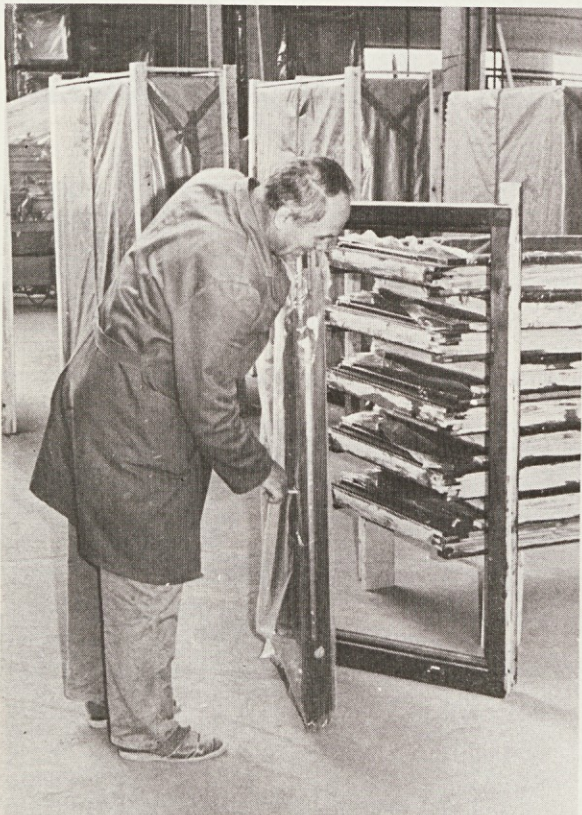
Zadnja kontrola oken pred odpremo. Okna morajo predvsem dobro tesniti in se lahko zapirati.
