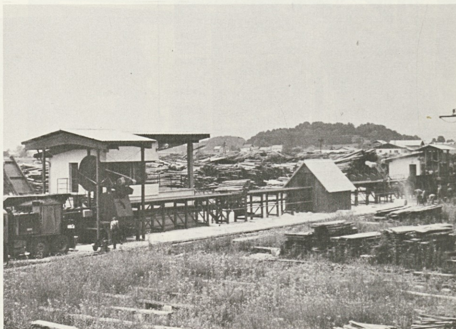
Prednji del linije (od desne proti levi) Lupilnik, elektronski merilnik in čelilnik hlodovine.
