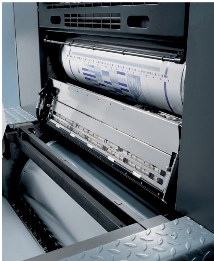
Integrirani kolorimeter Inpress Control meri odtise v stroju namesto na nadzorni mizi. Prihranimo najmanj čas za odvzem vzorčnih odtisov.
