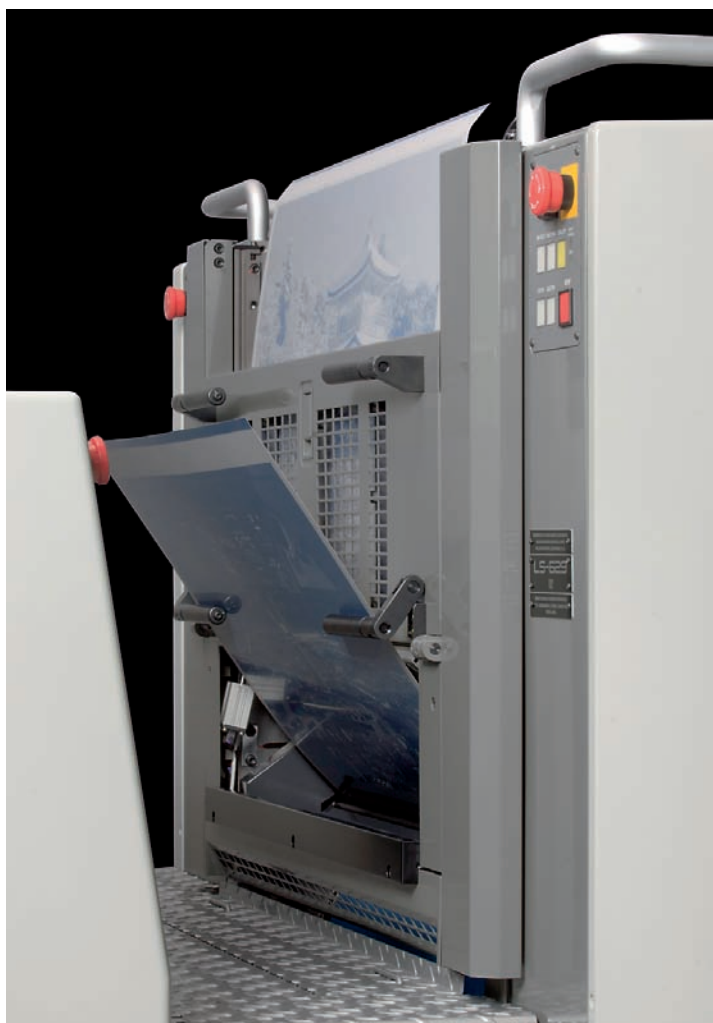
Slika 10. Na novo razviti izmenjevalnik tiskovnih form ima vsak tiskovni člen ofsetnega stroja Komori Lithrone LS29. Zamenjava štirih form traja dve minuti in pol in zagotavlja minimalna odstopanja barvnega skladja.
