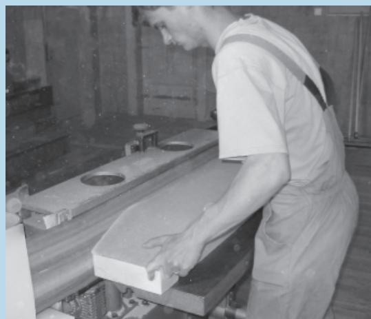
□ Slika 2. Obdelava modela na robnem brusilnem stroju
