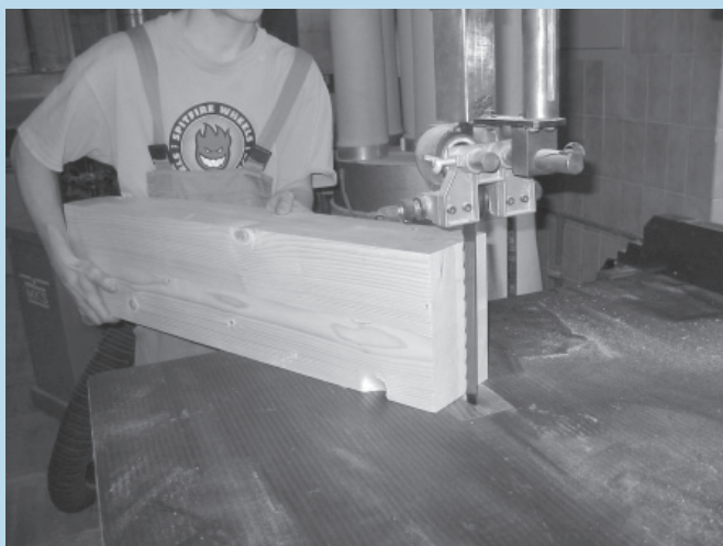
□ Slika 1. Obdelava zgornjega dela modela na tračnem žagalnem stroju
