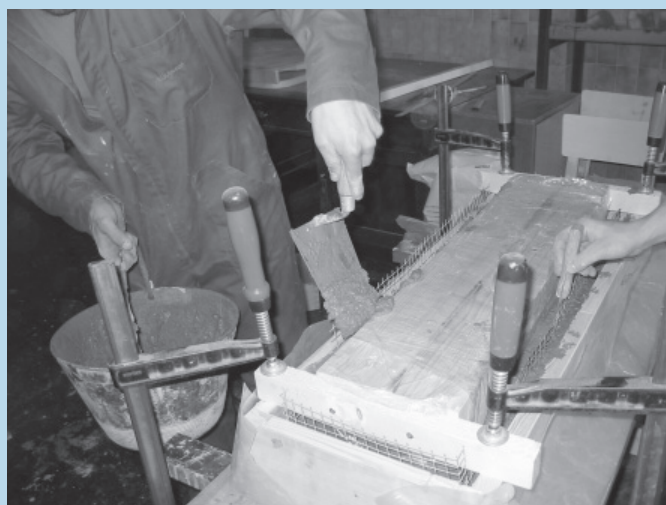
□ Slika 4. Izdelava spodnjega dela modela
