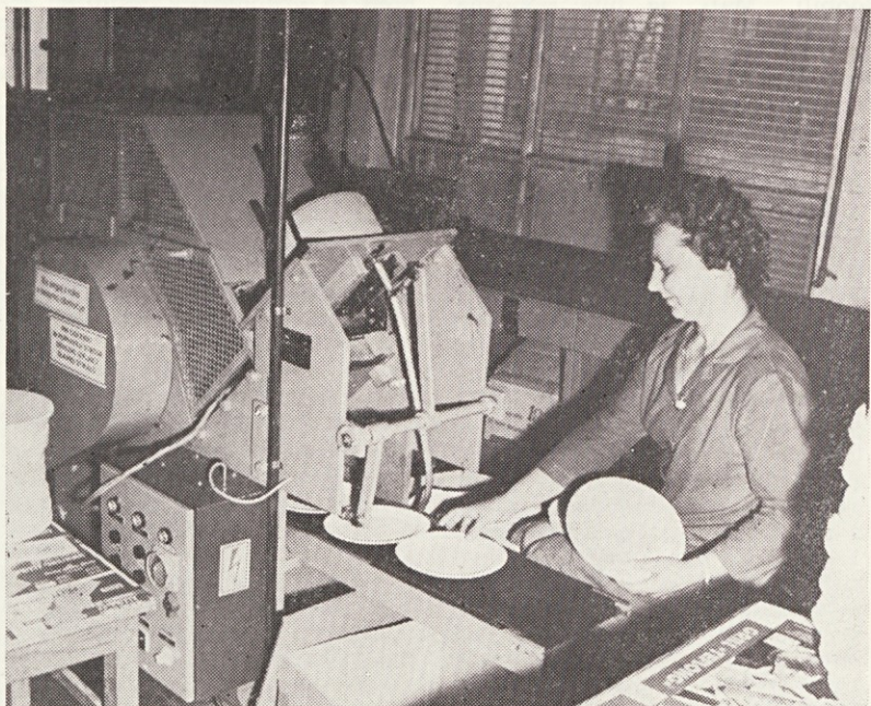
Stroj za izdelavo krožnikov nizozemski stroj tip »MARKHORST« dobavljen leta 1979.
